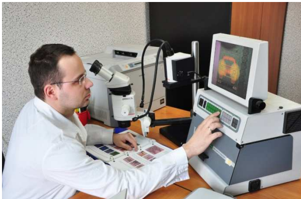
Ryc. 2 Stanowisko VSC-4 służące do technicznych badań dokumentów
