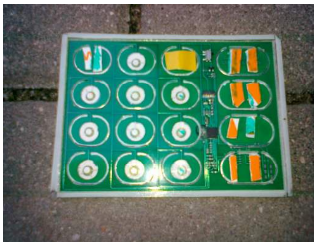
Fot. nr 7 materiał własny Zdjęcie wewnętrznej strony nakładki na klawiaturę z widocznymi po prawej stronie kośćmi pamięci służącymi do przechowywania numeru PIN danej karty płatniczej
