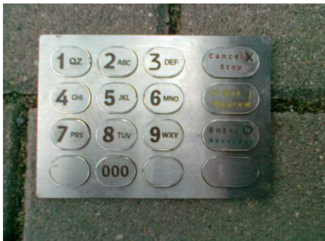
Fot. nr 6 materiał własny Zdjęcie zdemontowanej nakładki na klawiaturę bankomatu
